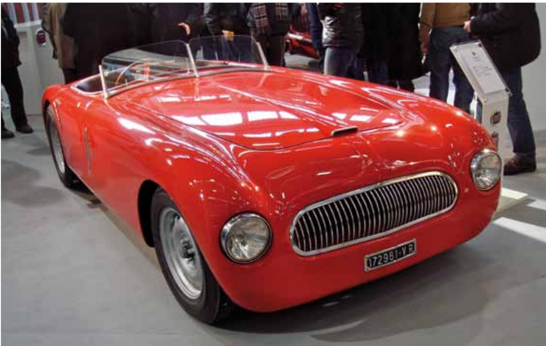
FIAT 1500 6 C sport corsa del 1949, cilindrata 1493 cc. con 70 cavalli a 5400 giri/min., peso a vuoto 850 kg. e velocità massima di circa 175 km/h.
