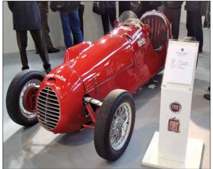
La Cisitalia del 1944, con un motore Fiat di 1089 cc di 45 cavalli e un peso di soli 300 kg. superava i 200 km all'ora!
